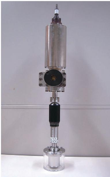
図3 佐賀県立九州シンクロトロン光研究センターとNICTが共同開発した小型イオンポンプ付きの可搬型超高真空試料搬送導入装置
