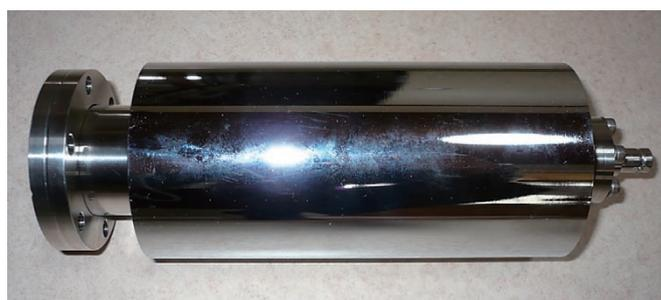
図2 電池駆動可能な小型の超高真空イオンポンプ
