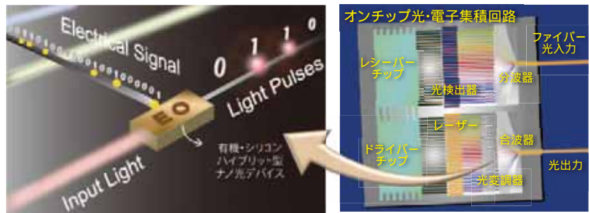
図1 超高速・光/電子融合集積チップの概念図。
